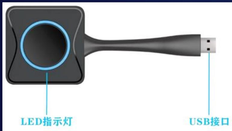
该投屏方式主要用于 windows 7 版本以上的 windows 系统的电脑和 Mac OS 系统的电脑投屏，只需将发射器接入电脑的 USB 接口，首次接入后需要运行 U 盘中的 ESHOW 驱动，运行后任务栏将出现 ESHOW 图标，提示“按键正在与主机建立连接”（此时发射器的指示灯呈蓝灯闪烁状态），连接成功后会提示“按键与主机连接成功，可分享”（此时发射器的指示灯呈蓝灯常亮状态），连接成功后按下按键即可分享画面到显示端（此时发射器的指示灯呈红灯常亮状态）。在视频矩阵上选择无线投屏>>>触摸屏、一体机1和一体机2来完成切换。
